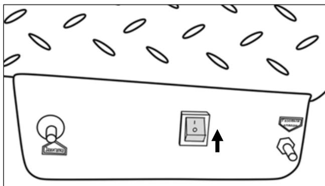
Рис. 2. Включение вентилятора
