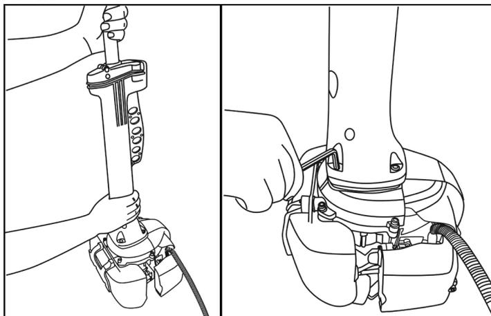
Рис. 6. Установка штанги
