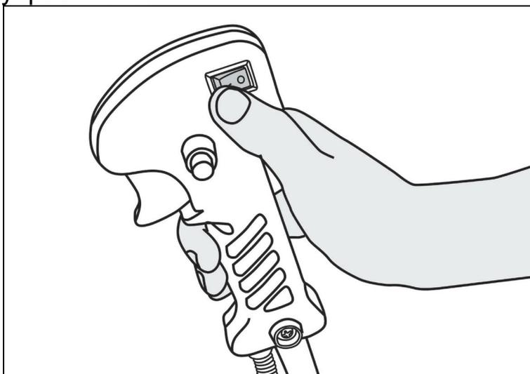
Рис. 21. Включение зажигания
