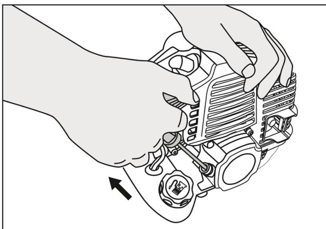
Рис. 25. Запуск двигателя
