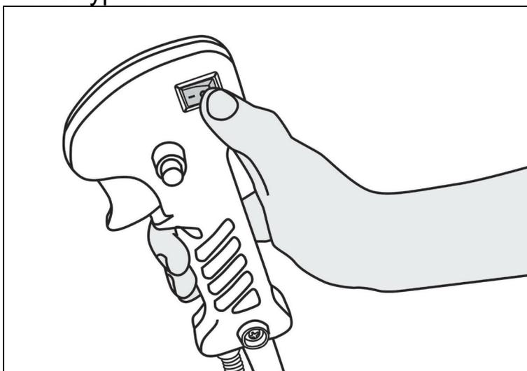
Рис. 26. Остановка двигателя
