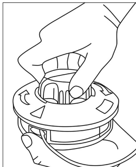
Рис. 30. Закручивание лески
