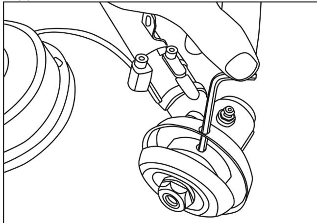
Рис. 8. Фиксация ступицы вала.
