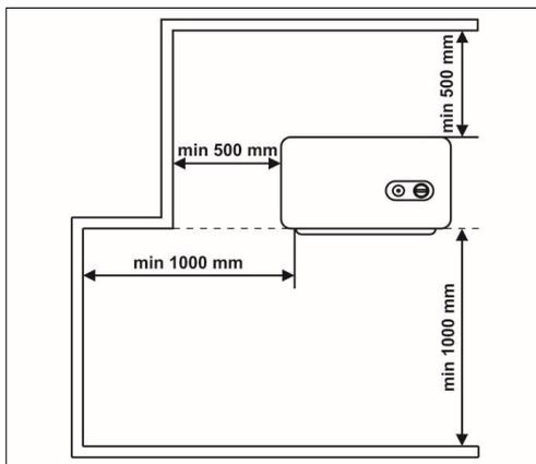
Рис. 2. Размещение обогревателя
